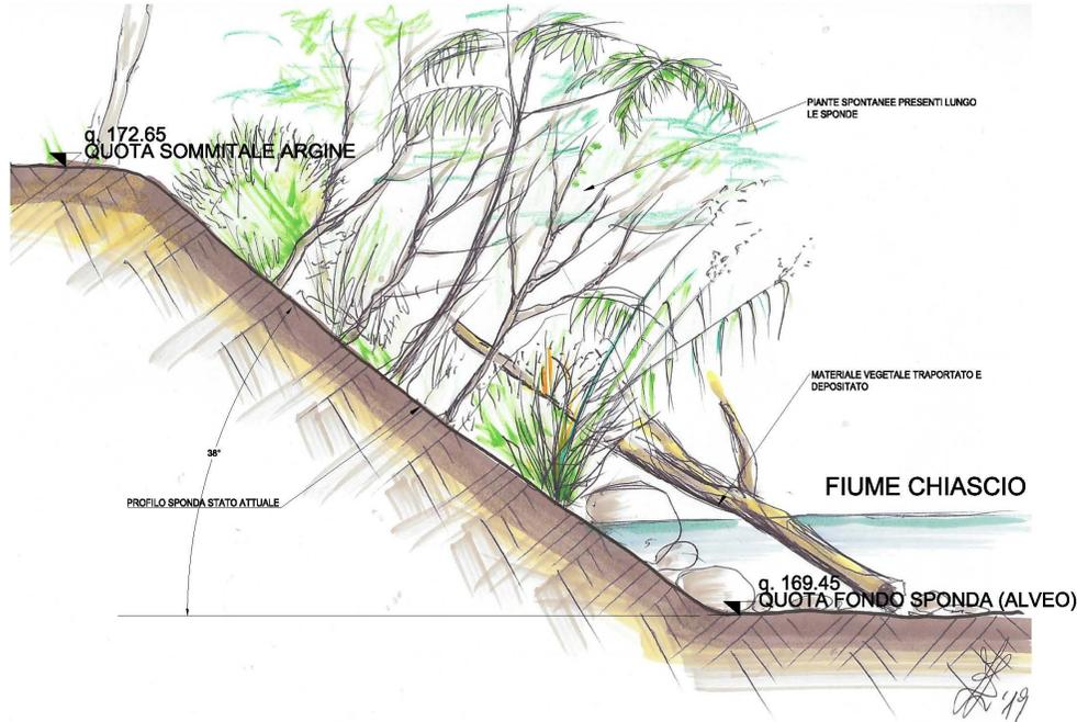
**PROGETTO - SEZIONE TIPOLOGICA SISTEMAZIONE SPONDA DX**
