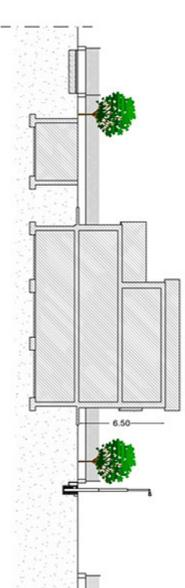
LA LINEA DEL TERRENO DELLO STATO DI PROGETTO COINCIDE CON LA LINEA DEL TERRENO DELLO STATO ATTUALE
